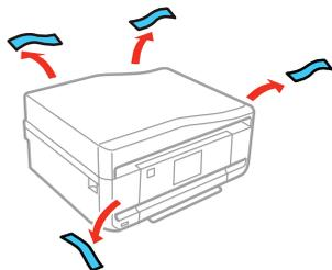
2 Levante la unidad del escáner y retire todo el material de protección.
